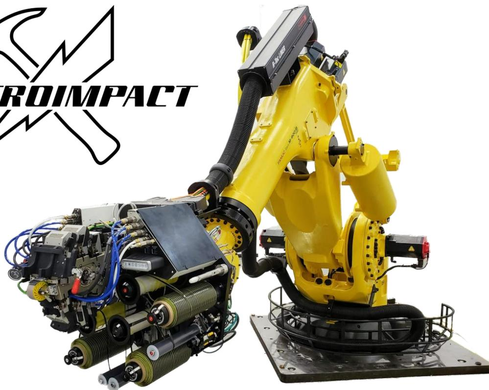
Electroimpact (エレクトロインパクト) 社製 Scorpion (スコーピオン) は、インダストリー4.0 を体現した、高性能・超高速・低価格な複合材自動積層装置 (ロボット) です。
